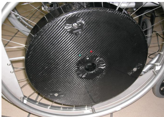
Fig. 6 : Roue dynamométrique TSR (Mérignac, France).
