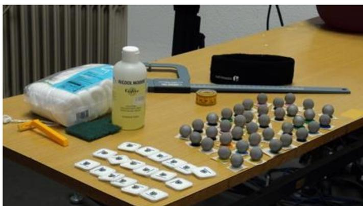
Figure III.2a : Marqueurs réfléchissants, électrodes EMG et petits matériels de pose des capteurs et mesures anthropométriques.
