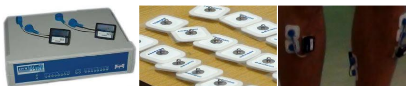
Figure IV.4. Système d'enregistrement EMG (gauche), électrodes EMG de surface (milieu) et exemple de positionnement sur la jambe d'un participant.
