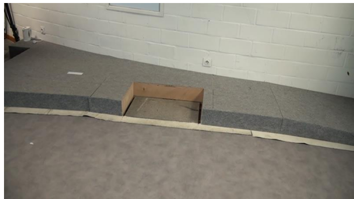
Figure III.8: Le trottoir amovible formé de différents 'caissons', ainsi que les 2 PFF respectivement dans le trottoir et dans la chaussée recouverte de linoléum.
