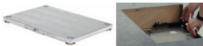
Figure IV.3. Plate-forme de force Kistler type 9286AA et son insertion dans le plancher.
